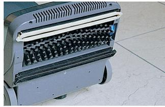
Double raclette pour le séchage à l'avant et à l'arrière de la brosse. Brosse en PP adaptée aux surfaces les plus communes et brosse délicate pour le nettoyage de la moquette
