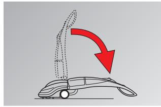
Hauteur de travail minimale de 200 mm qui permet un nettoyage parfaite sous les meubles, les chaises, les tables, les lits, etc. La poignée inclinable rend l'utilisation quotidienne de la machine facile et pratique pour l'utilisateur. La capacité du réservoir est grande afin d'éviter les arrêts fréquents pour le remplissage.
